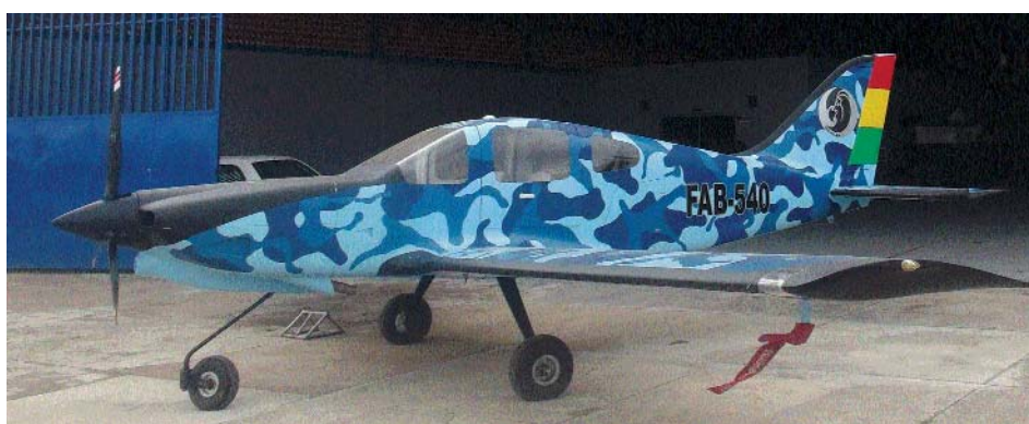
El "Gavilán" y el "Tiluchi" ensamblados en Bolivia a partir de la estadounidense "Team Tango".
